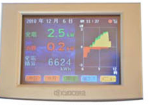
発電量と消費電力をモニターで確認
